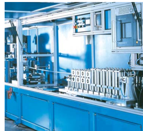
Контроль сварного шва алюминиевых труб
