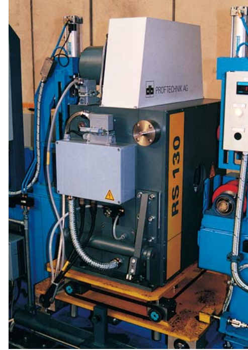
Автономная проверка светлотянутой стали с помощью вращающейся системы RS 130
