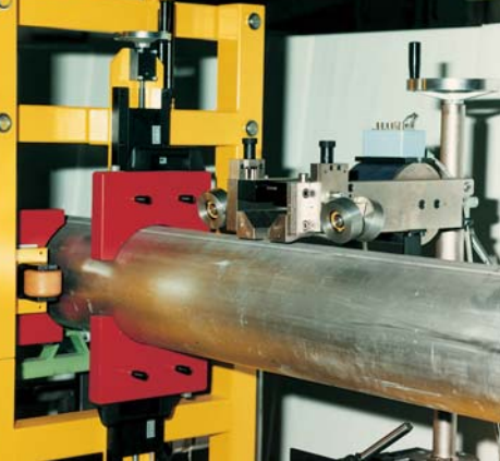
Неразрушающая проверка качества сварного шва с помощью многосегментных катушек
