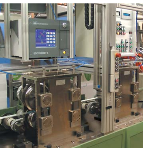
Проверка сварного шва алюминиевой трубы радиатора
